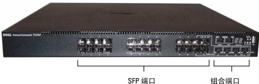
图 1-3. PowerConnect 7024F, 具有 24 个 SFP 端口
