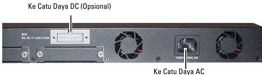
Gambar 1-15. Hubungan Daya AC dan DC ke Switch
